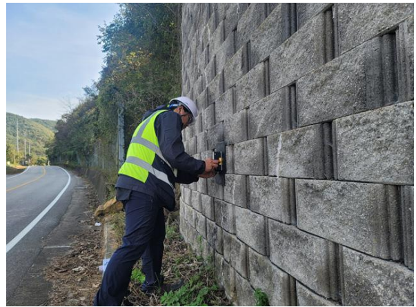
경사계를 이용한 경사도 측정사진
